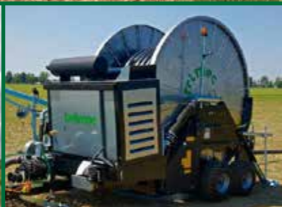
Cabina insonorizzata sollevabile idraulicamente Acoustic kit
