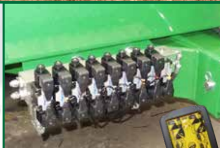
Radiocomando per movimentazione idraulica Remote control for hydraulic movements
